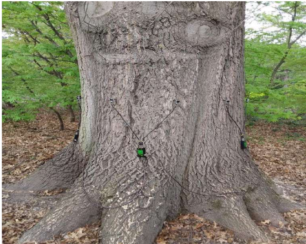
2. ábra ArborSonic 3D akusztikus tomográf Quercus palustris (17.) törzsén
